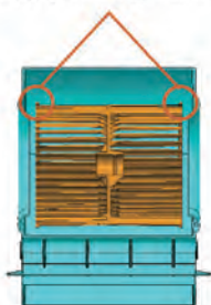
Конструкція колеса для запобігання зворотному потоку повітря
